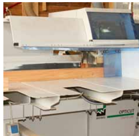
Querabschub aus dem Schnitt für bequemes Abnehmen der Werkstücke
