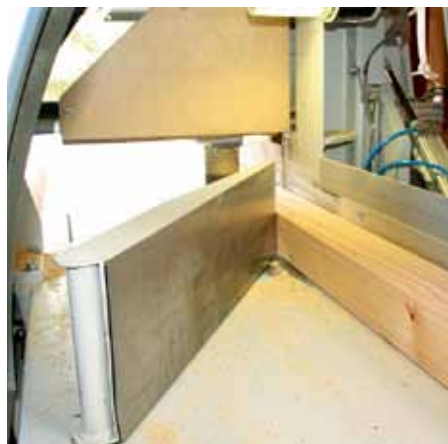
Für ein genaues Kappergebnis: Seitendruck vor und nach dem Kappschnitt bei der OptiCut S90 XL
